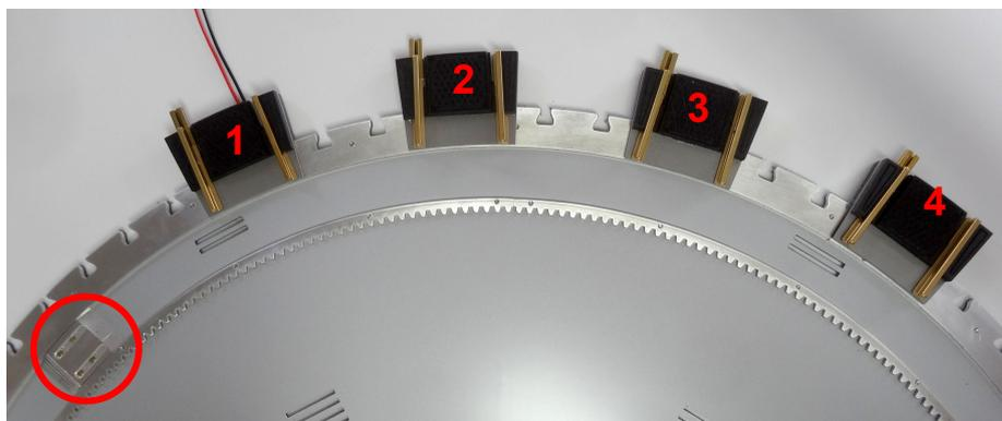
Wir haben zum Test schon 4 Abgänge mit dem Wert 1 gesetzt: CV 191, CV 195, CV 199 und CV 203. Diese stehen auf den Positionen 1,5,9 und 13. Alle anderen Positionen sind auf den Wert 0 eingestellt und somit nicht aktiv. In der anschließenden Tabelle sind für alle Abgangspositionen Programmierbeispiele mit dazugehörigen Weichenadressen aufgelistet.
